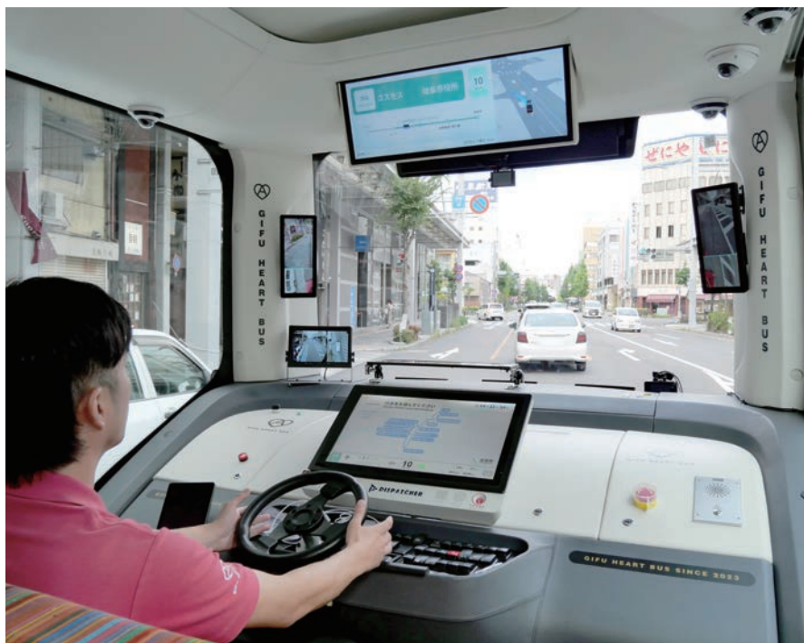
写真3 自動走行中の「ロボバス」の運転席の様子。 オペレーターはハンドルに手を触れていない（2026年8月、筆者撮影）
