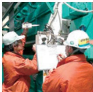
工場内の設備が停止した静寂時に実施されたエア漏れ聴音検査。
