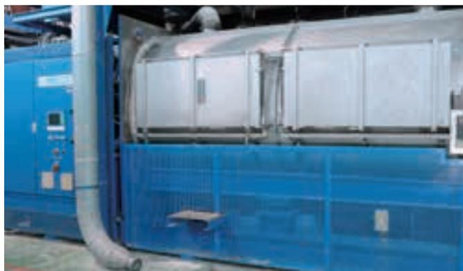
洗濯機 羽毛専用の洗濯機。明和町の「還元力が非常に強い超軟水」と独自の「研ぎ洗い」により、羽毛を傷めずに細部まで洗浄できる。
