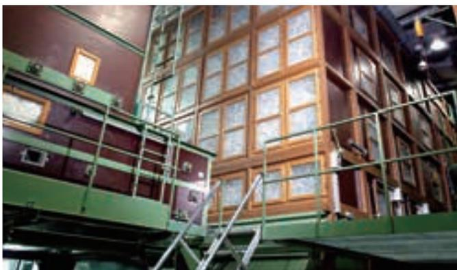
選別機 乾燥させた羽毛を選別機に入れ、混じっているフェザー(羽根)を風で飛ばし分け。羽根は重いため手前に落ち、羽毛は軽いため奥まで飛ぶ。
