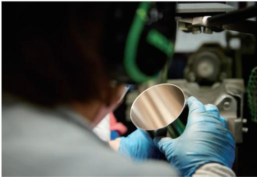
カクテルシェーカーの内部を磨く作業。約10種類の特特殊な研磨ブラシを細かく変えながら仕上げている。
